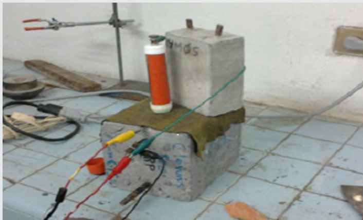
Figura 2.5. Medición de potenciales de corrosión.
