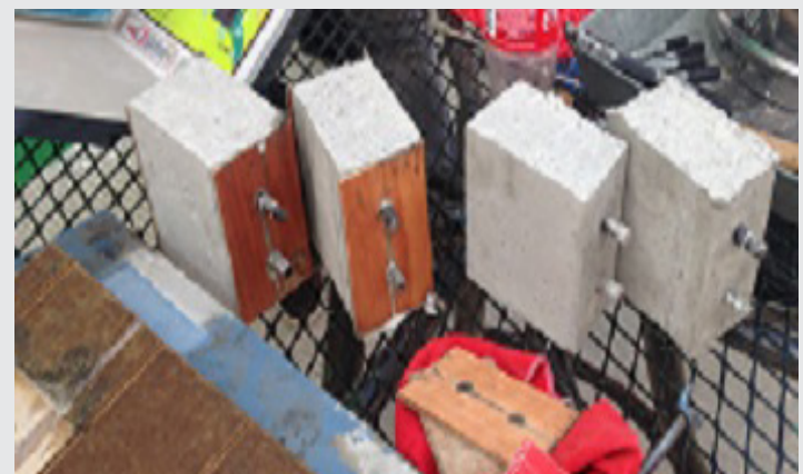
Figura 2.3.1. Descimbrado y colocación de curado de los especímenes de concreto.
