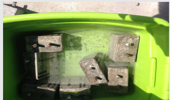
Figura 2.4. Vigas de concreto en experimentación y curado.
